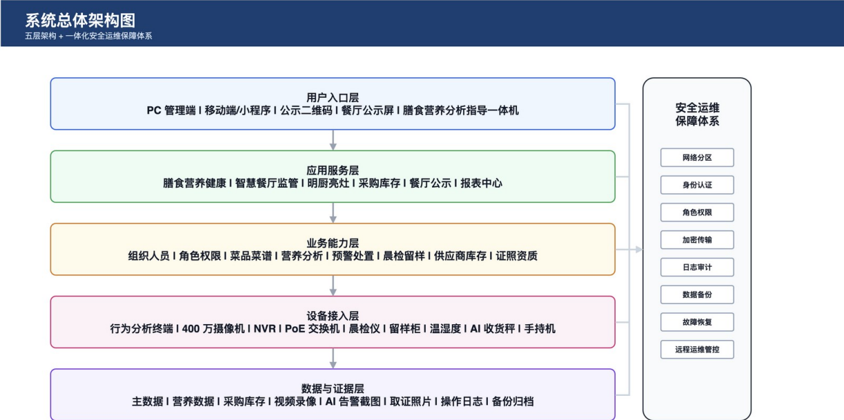
图 1 系统总体架构图
